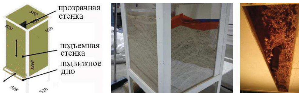
Рисунок 1 – Схема модели бункера с картиной сегрегации и сводаобразования зависших опилок
