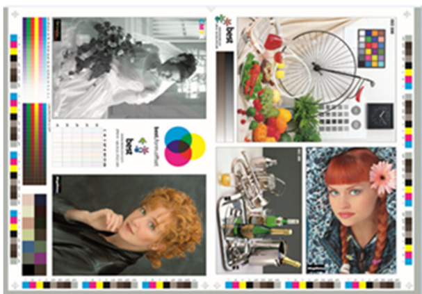
Рис. 2. Комплексный тест-объект для оценки качества полиграфического воспроизведения
