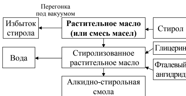
Рис. 4. Схема получения алкидно-стирольной смолы по методу 2
