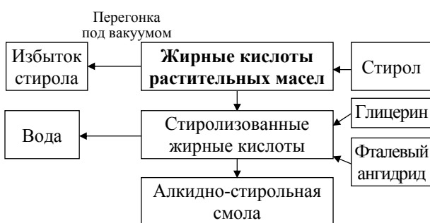
Рис. 1. Схема получения алкидно-стирольной смолы по методу 1
