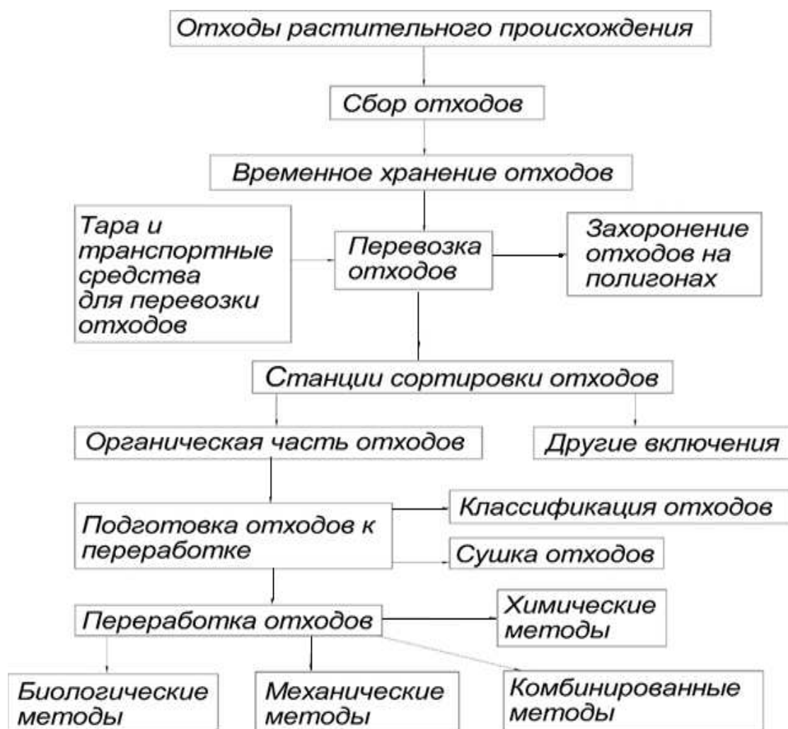
Рисунок 1 – Система обращения с отходами растительного происхождения
