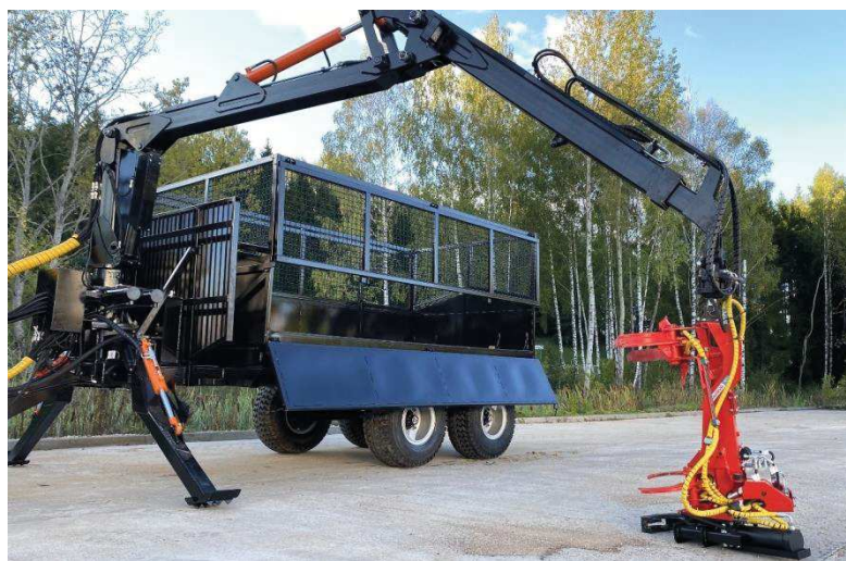
Рисунок 2 – ТИГЕР 7-710Щ с харвестерной головкой Naarva S23
