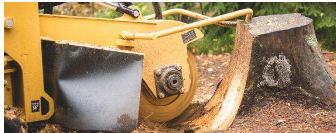
Рисунок 2 – Рабочий орган дискового мульчера
