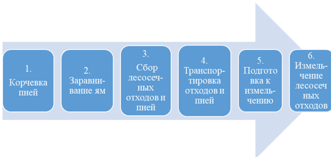
Рисунок 5 – Операции технологии очистки лесосек с эффективным использованием древесного сырья и обеспечением прямолинейной посадки лесных культур
