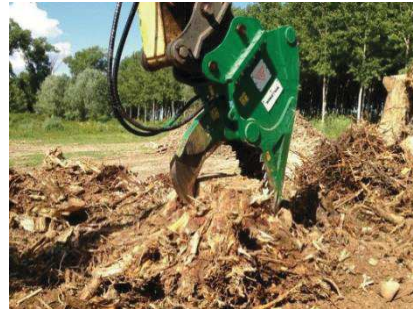
Рисунок 3 – Корчеватель, работающий по методу прямого толкающего воздействия (а); корчеватель на базе одноковшового экскаватора (б)
