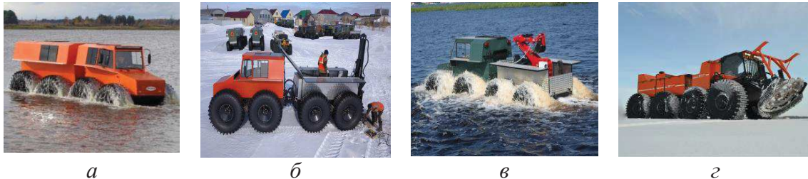
а – плавающий вездеход грузопассажирский; б – плавающий вездеход с буровой установкой; в – плавающий вездеход с экскаваторной установкой; г – плавающий мульчер
