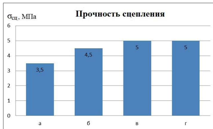
Рис. 9. Гистограмма прочности сцепления полимерных покрытий на основе СВМПЭ, модифицированных нанокремнеземными компонентами: а – СВМПЭ без модифицирующих добавок; б – СВМПЭ с модифицирующей добавкой 10 об. % графита; в – СВМПЭ с модифицирующей добавкой 5 об. % фуллереновой сажи; г – СВМПЭ с модифицирующей добавкой 10 об. % фуллереновой сажи
