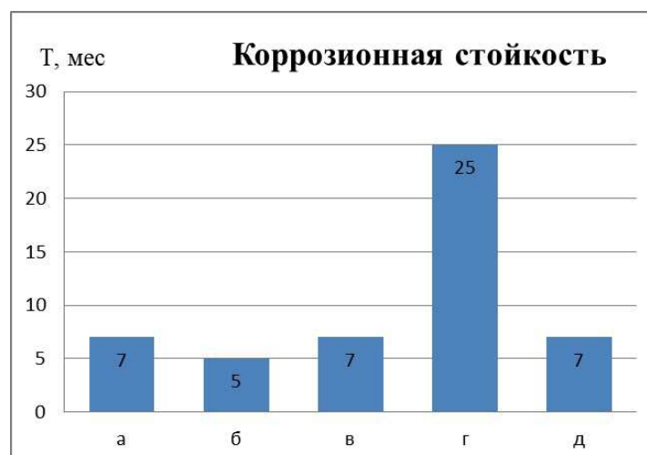
Рис. 7. Гистограмма коррозионной стойкости полимерных покрытий на основе СВМПЭ марки GUR-4120, модифицированных нанокремнекислотными компонентами: а – СВМПЭ без модифицирующих добавок; б – СВМПЭ с 10 об. % графита; в – СВМПЭ с 5 об. % модифицирующей добавки в виде фуллереновой сажи; г – СВМПЭ с 10 об. % модифицирующей добавки в виде фуллереновой сажи; д – СВМПЭ без модифицирующих добавок, нанесенный на отдробеструенную поверхность
