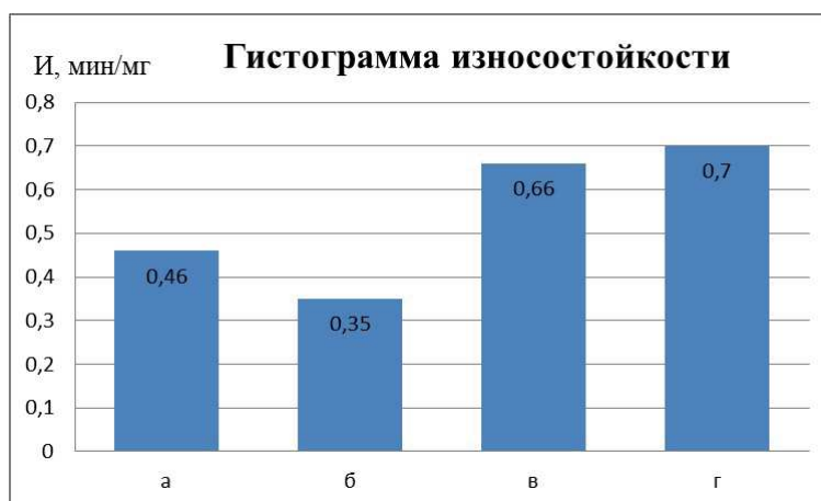
Рис. 4. Гистограмма износостойкости полимерных покрытий на основе СВМПЭ, модифицированных нанокремнеземными компонентами: а – СВМПЭ без модифицирующих добавок; б – СВМПЭ с модифицирующей добавкой 10 об. % графита; в – СВМПЭ с модифицирующей добавкой фуллереновой сажи 5 об. %; г – СВМПЭ с модифицирующей добавкой фуллереновой сажи 10 об. %
