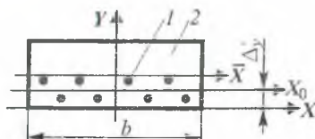
1 – армирующий элемент; 2 – матрица Рисунок 8 – Поперечное сечение стержня
