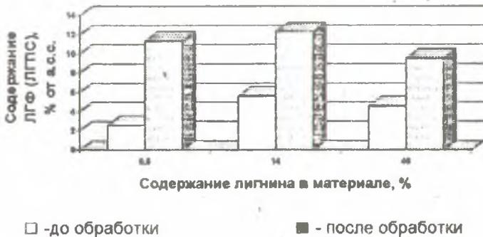
Рис.2. Влияние лигнина на содержание ЛГФ при обработке целлюлозосодержащих материалов в ЭМП СВЧ.
