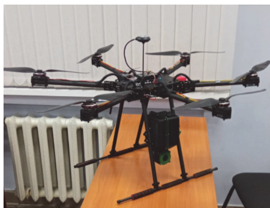
Рис. 2 БПЛА для рассеивания трихограмм
