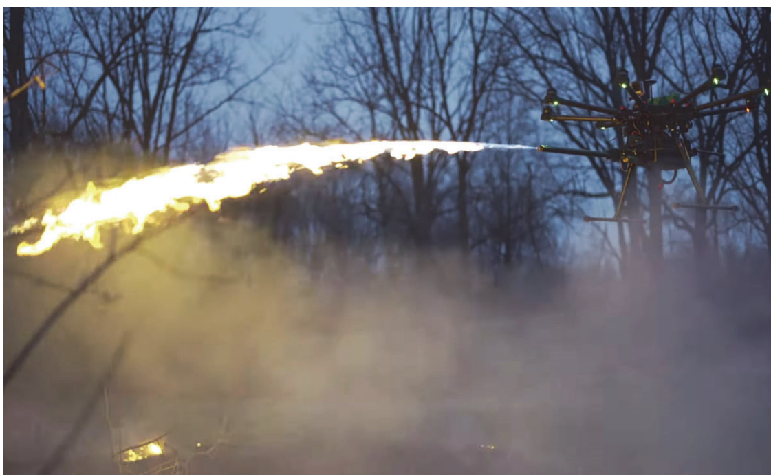
Рис. 2. Использование огнемёта с БЛА
