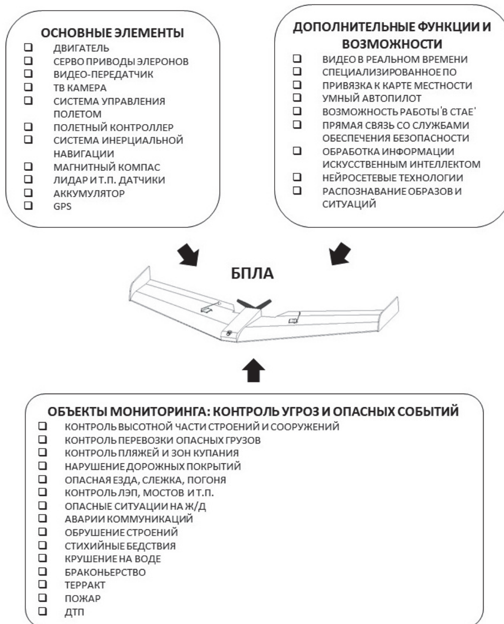
Рис.1 Структура комплексного мониторинга безопасности сложного объекта (на примере мегаполиса-миллионника) с применением БПЛА типа «летающее крыло»
