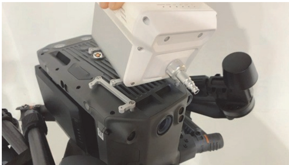
Рис. 1. Мобильный газоанализатор для БПЛА
