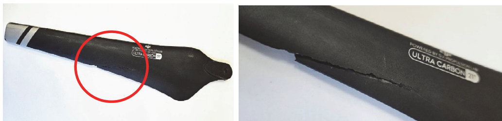
Рис. 2. Повреждения исходной детали
