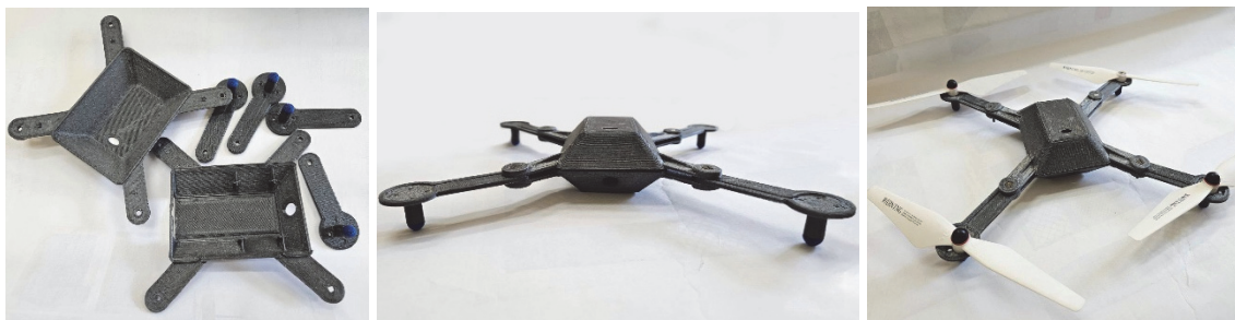
Рис. 2. Напечатанные детали корпуса квадрокоптера
