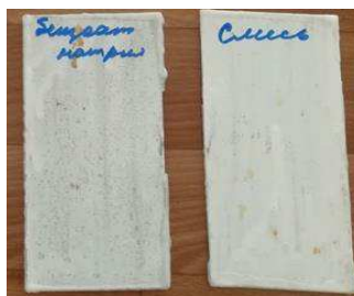
Рисунок 2 – Пластины, покрытые грунтовками с бензоатом натрия и смесью бензоата натрия и нитрита натрия (слева направо), в климатической камере спустя 480 часов
