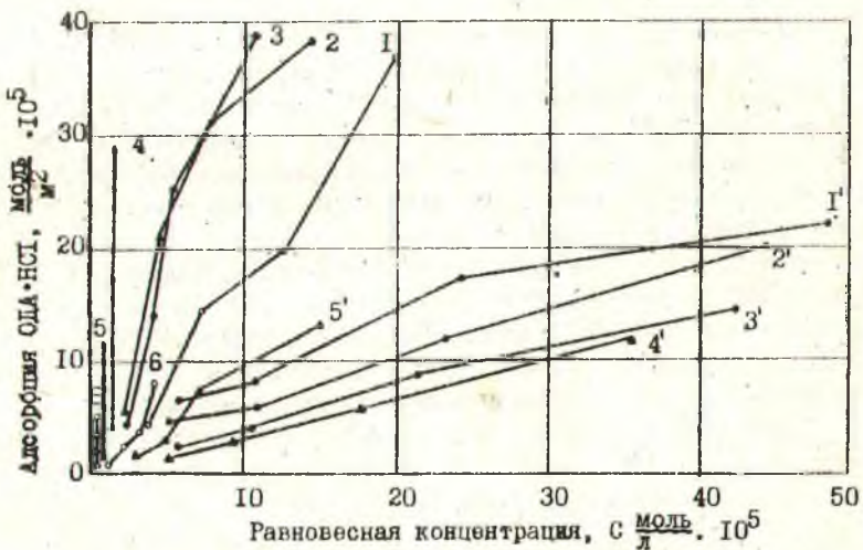
Рис. 1. Адсорбция ОДА·НСІ силивином 1-6 и галитом 1' - 6' различной крупности:
