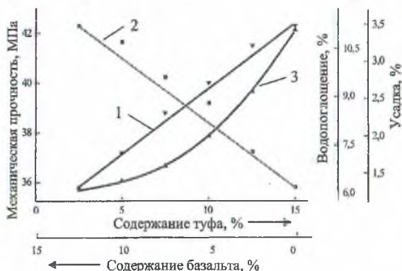
Рисунок 1 – Зависимость механической прочности (1), водопоглощения (2) и усадки (3) керамических плиток от содержания туфа и базальта
