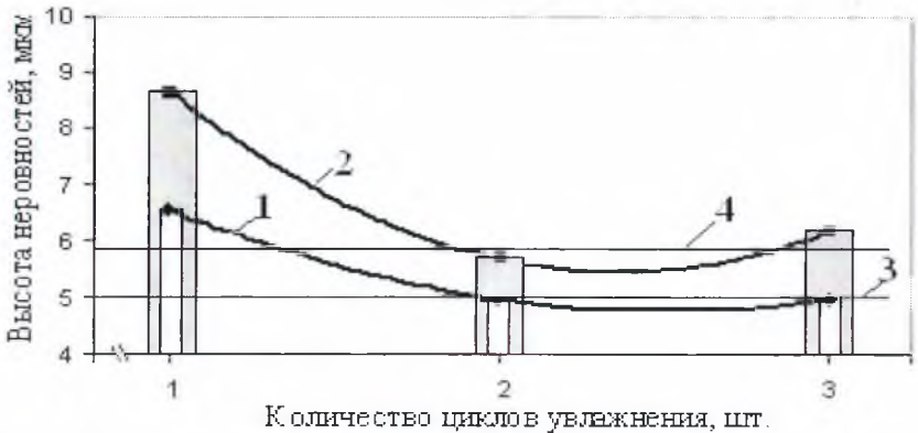
Рис. 5. Влияние количества циклов увлажнения древесины на глубину неровностей лакокрасочных покрытий: 1 – мелкослойная древесина; 2 – широкослойная древесина; 3 – состояние поверхности мелкослойной древесины до увлажнения; 4 – состояние поверхности широкослойной древесины до увлажнения
