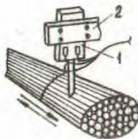
Рис.3. Схема установки для исследования присоединенной массы пакета: I - пружина; 2 - рама.
