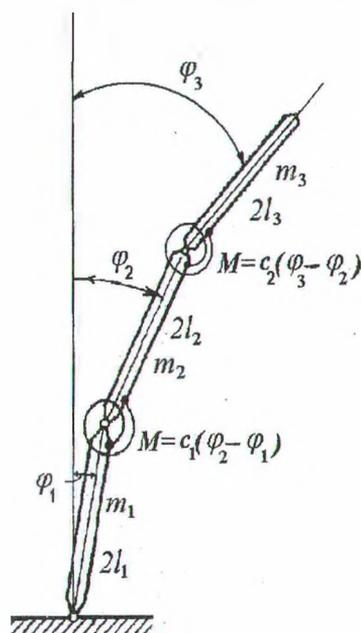
Рис. 1. Многоступенчатая модель ствола дерева
