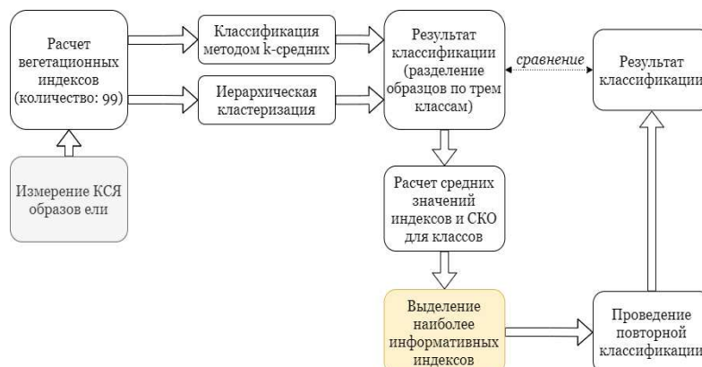
Рисунок 1 – Алгоритм определения наиболее информативных вегетационных индексов
