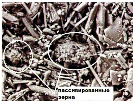
Рис. 3. Микрофотография образцов осадков, полученных при сернокислотном разложении фосфорита марки К-10 (увеличение \times 1000 , концентрация кислоты 45 %)
