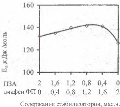
Рис. 4. Зависимость  $E_d$  для ненаполненных резин на основе НК от соотношения компонентов внутри комбинации диафен ФП+МШ-55
