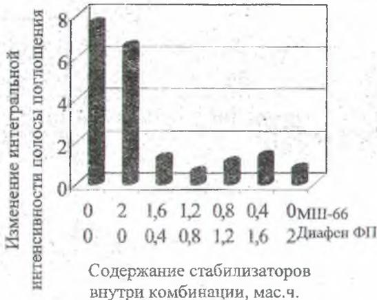
поглощения образца до и после старения соответственно. Наименьший прирост соответствует наименьшему количеству накопленных на поверхности дикетонов в процессе деструкции макромолекул каучука и, соответственно, более эффективной защите вулканизата. Согласно этому, наибольшей эффективностью обладает комбинация диафен ФП+МШ-66 (2:3).
