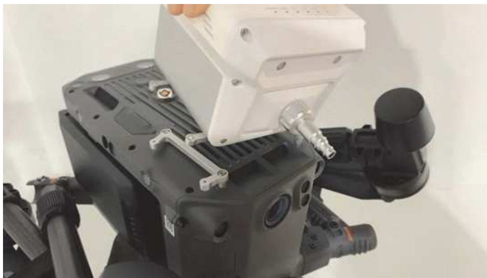
Рис. 1. Мобильный газоанализатор для БПЛА
