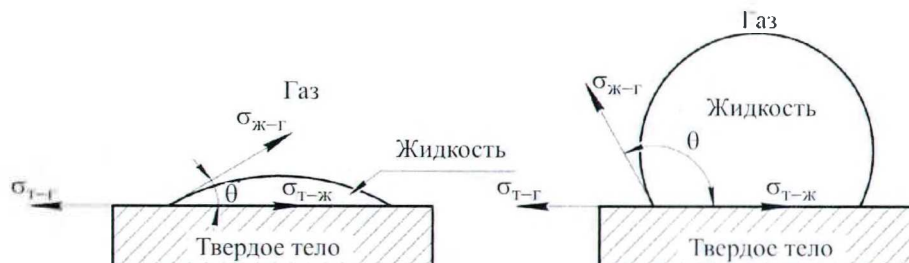
Рис. 2. Структурная схема установки по определению краевого угла смачивания пластмасс: а — жидкость смачивает поверхность твердого тела; б — жидкость не смачивает поверхность твердого тела
