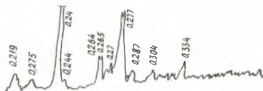
Рис. 3. Рентгенограмма микрогранул цементной сырьевой смеси, термообработанной в декарбонизаторе. Опытная установка (В). Тг = 960°C.
