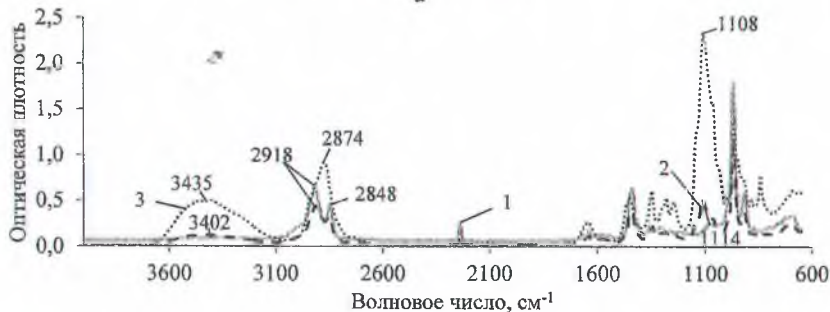
1 – поверхность немодифицированного образца; 2 – внутренний скел модифицированного образца; 3 – поверхность модифицированного образца Рисунок 3 – ИК-спектры образцов вулканизатов на основе БНКС-28, немодифицированного и модифицированных в среде ПЭГ 400 (а) и комбинации ПЭГ 400 + ПЭГ 4000 (б)
