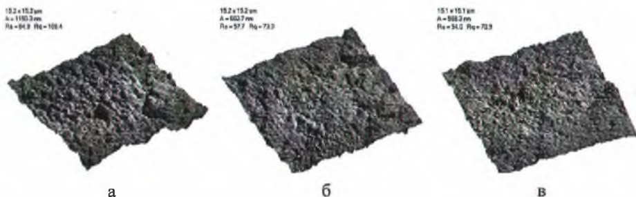
а – образец немодифицированного вулканизата; б – образец вулканизата, модифицированного в ПЭГ 400; в – образец вулканизата, модифицированного в ПЭГ 400 + ПЭГ 4000
