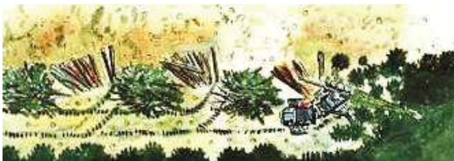
Рисунок 1 – Приемы работы харвестера при совместной заготовке сортиментов и древесной кроны
