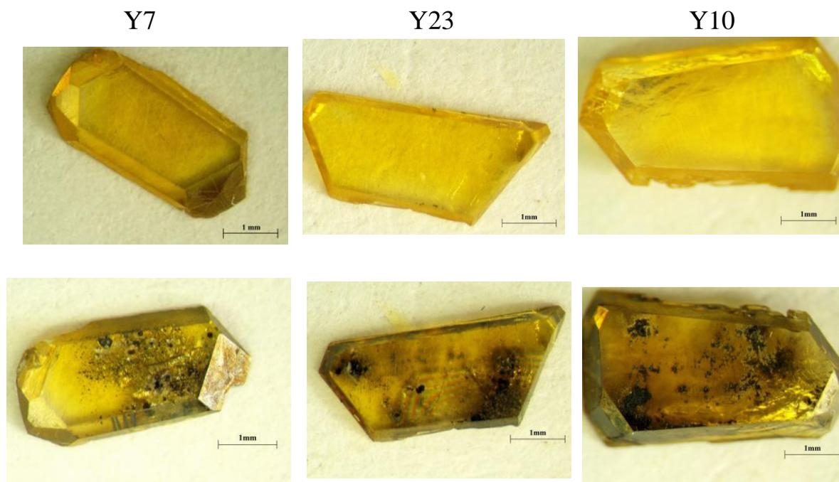
**Рисунок 2 – Фотографии образцов до графитизации (сверху) и после (снизу)**
