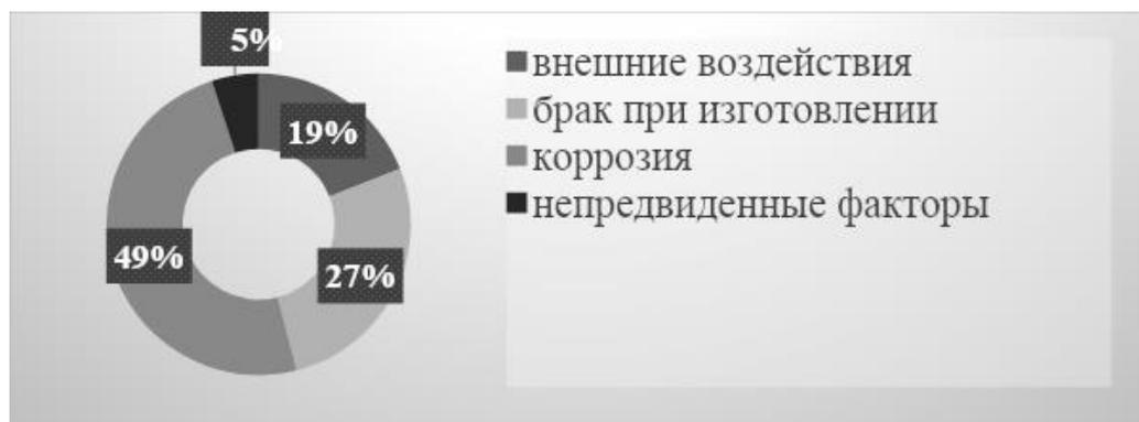
Рисунок 1 – Основные причины аварий и неисправности оборудования в газовой промышленности
