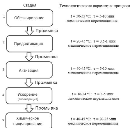
**Рисунок 1 – Схема технологического процесса химической металлизации ВПЯМ**
