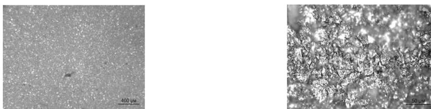
**Рисунок 1 – Морфология электролитически осаждённого железа при температуре 90 °С и плотности тока 10 А/дм<sup>2</sup>.**
