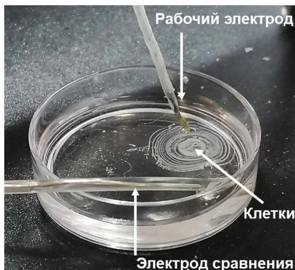
**Рисунок 1 – Схема изучения клеточной коммуникации с использованием гидроксиапатитных паттернов и ион-селективных электродов**
