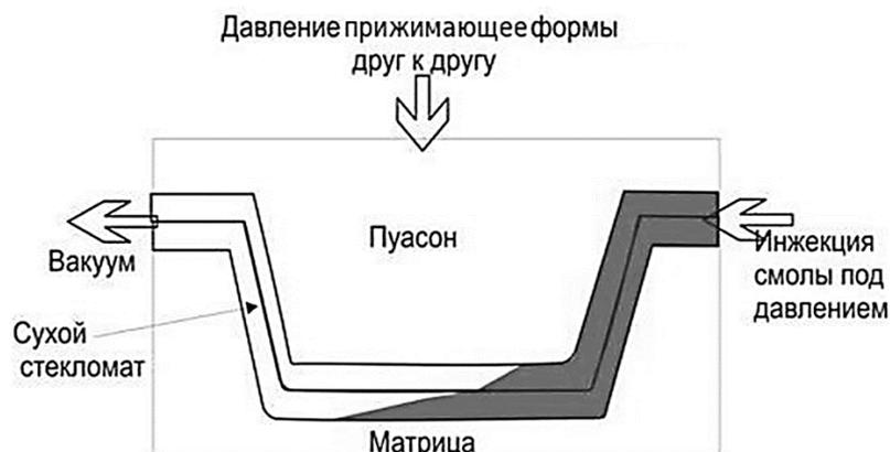
**Рисунок 3 – Технологическая схема метода RTM**
