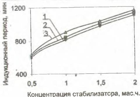
Рис.1. Зависимость индукционного периода окисления каучука СКИ-3 от концентрации стабилизатора при  $T = 140^\circ\text{C}$ ,  $P_{O_2} = 760 \text{ мм.рт.ст.}$ : 1 - диафен ФП, 2 - диафен ФДМБ, 3 - ДЦДМ.
