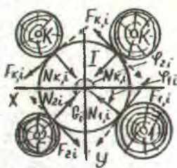
Рис.3. Система сил, действующих на бревно в пачке.
