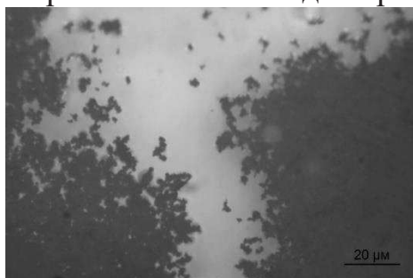
Рисунок 2 – Фотография MnO 2 , полученного при электроэкстракции из 10 % H 2 SO 4 щел.эл+сол.эл
