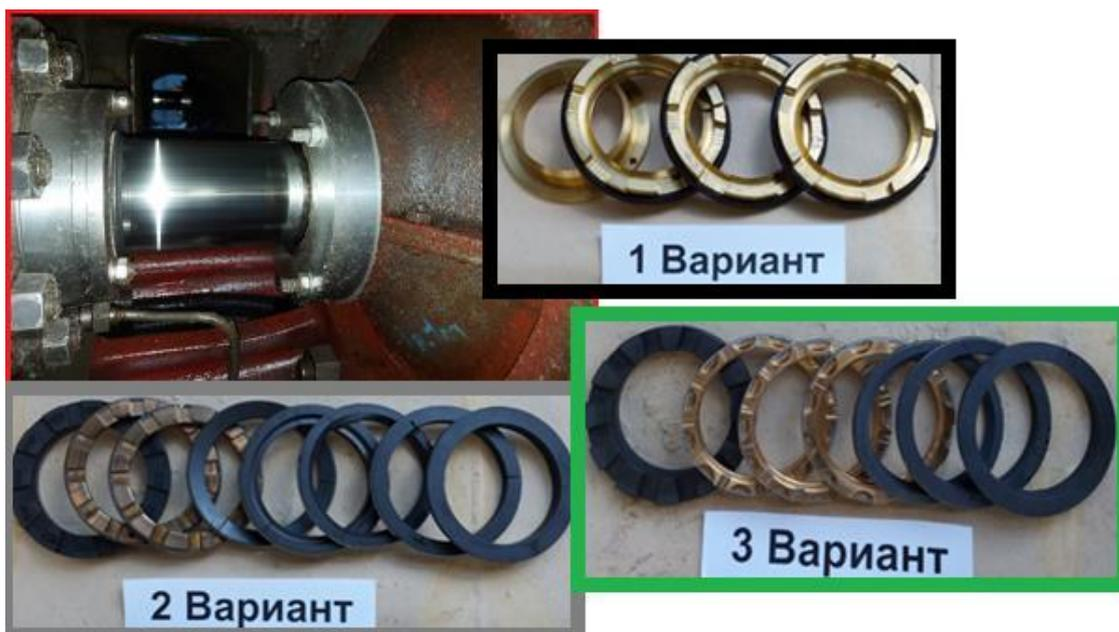
**Рисунок 1 – Варианты исполнения маслосъемных уплотнений компрессора**
