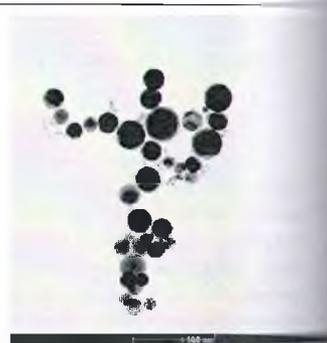
ПЭМ изображения наночастиц золота полученных методом лазерной абляции в воде
