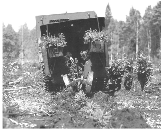
Рис. 3.6. Лесопосадочная машина МЛУ-1: а – схема конструкции: 1 – рама; 2 – навесное устройство; 3 – место сажальщика; 4 – ящик для семян; 5 – посадочный аппарат; 6 – привод посадочного аппарата; 7 – уплотняющий каток; 8 – подвижная рама; 9 – сошник; 10 – предохранительный нож сошника; б – процесс механизированной посадки саженцев
