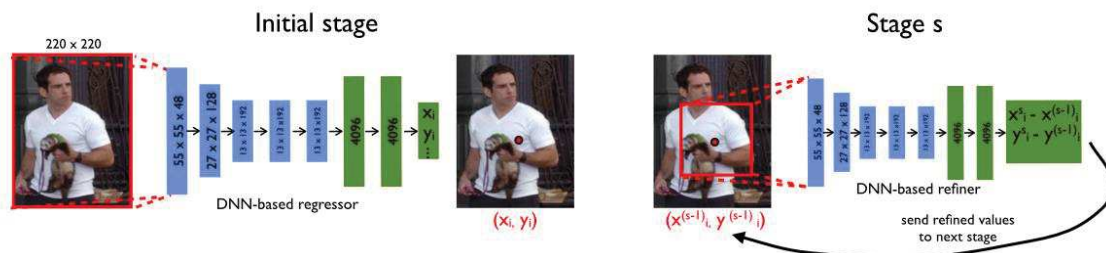
Рисунок 1 – Слева: Схематический вид DeepPose. Слои сети обозначены с собственными измерениями: сверточные слои – синие, полносвязные – зеленые. Справа: на стадии s уточняющий регрессор применен к части изображения для уточнения предсказания предыдущей стадии
