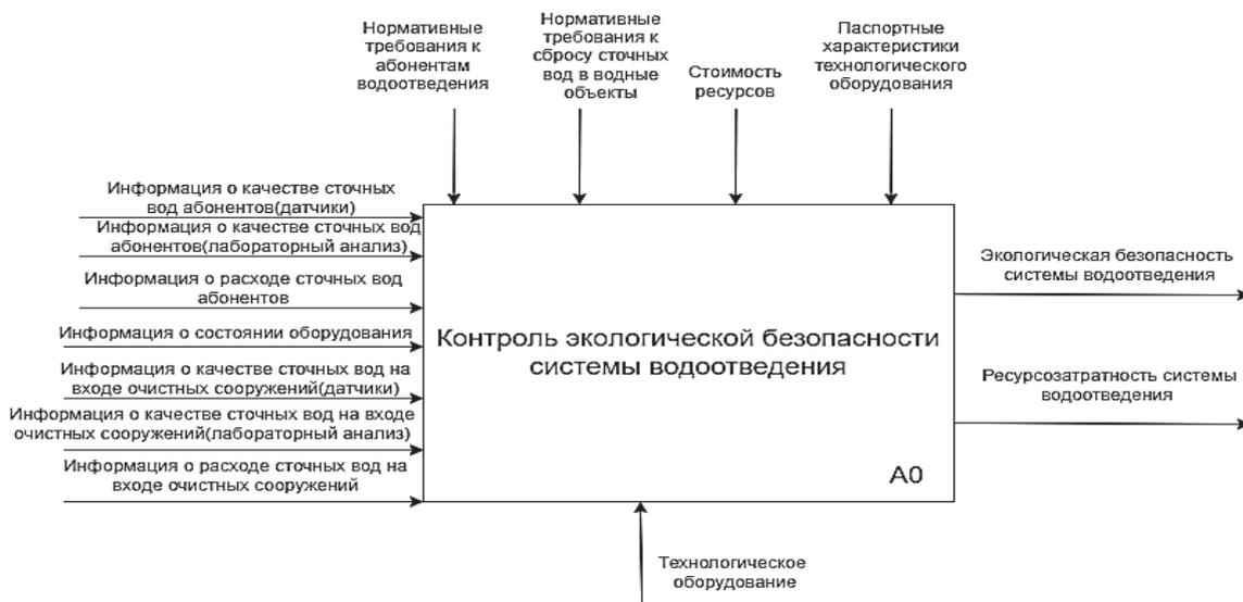
Рис. 2. Контекстная диаграмма системы контроля экологической безопасности водоотведения
