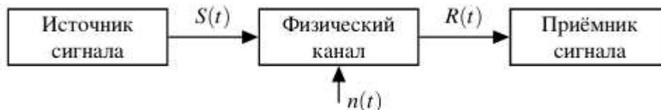
Рисунок 1 – Структурная схема физического канала в общем виде
