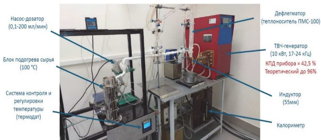
Рисунок 1 – Проточная установка крекинга углеводородного сырья в условиях индукционного нагрева
