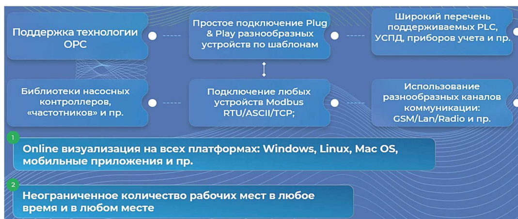
Рисунок 2 – Характеристики реализации ресурсного цифрового двойника предприятия на базе функционирующей SCADA-системы
