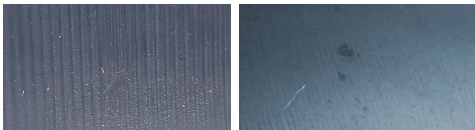
Рисунок 2 – Виды брака при шлифовании поверхности полимерного материала
