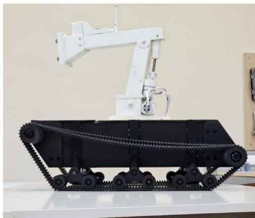
Рис.1- Гусеничный ход робота, с шарнирными деталями
