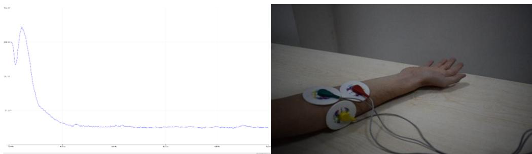
**Рис. 2 - Результаты электромиографического датчика (мышечная релаксация)**
