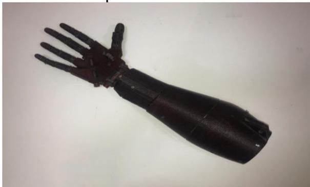
**Рис. 7 - Распечатанная на 3D принтере роботизированная рука**
