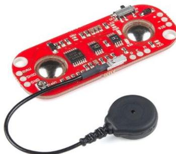
**Рис. 1 - MyoWare Muscle Sensor (AT-04-001) электромиографический датчик**
