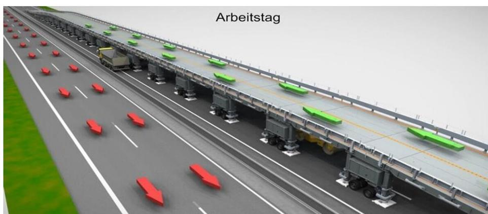
**Рис. 3 - Модульный передвижной мост для проведения ремонтных работ**
