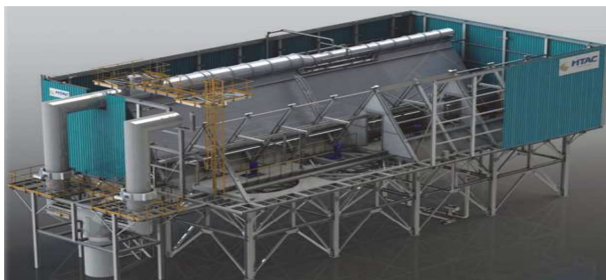
Рисунок 1 – Принципиальная схема конструкции воздушного охладителя
