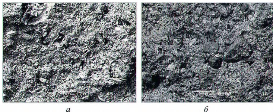
Рис. 4. Электронно-микроскопическое изображение поверхности сколов образцов керамических плиток
