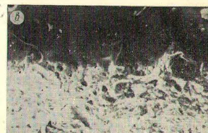
Рис. 1. Промежуточный слой в системе глазурь — керамическая основа (X720) Температура обжига 980°C, выдержка при максимальной температуре 2 ч; а — масса № 1, глазурь № 221; б — масса № 2, глазурь № 221; в — масса № 3, глазурь № 164
