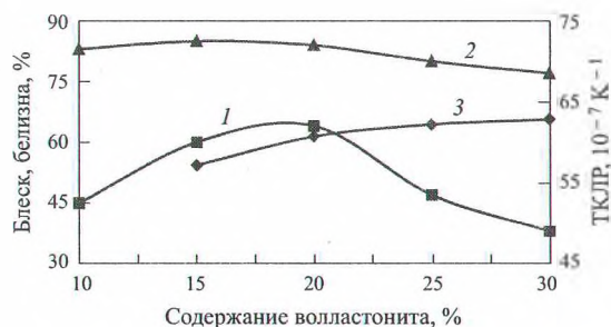
Рис. 3. Зависимость физико-химических свойств от состава 1 — блеск; 2 — близина; 3 — ТКЛР
