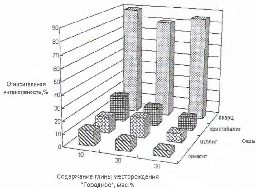
Рис. 2. Зависимость интенсивности фазообразования от состава исследуемых керамических масс при температуре обжига 1100 °С
