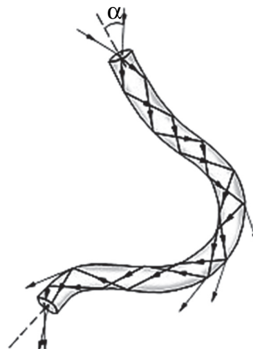
Рис. 80. Распространение света в волоконном световоде
