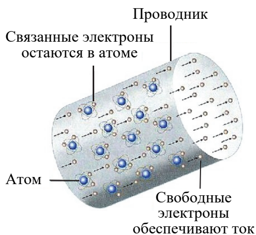
Рис. 59. Механизм электропроводности проводника
