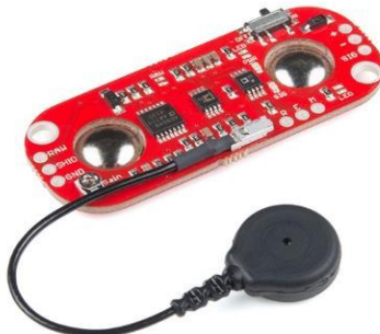
Рис. 1 - MyoWare Muscle Sensor (AT-04-001) электромиографический датчик
