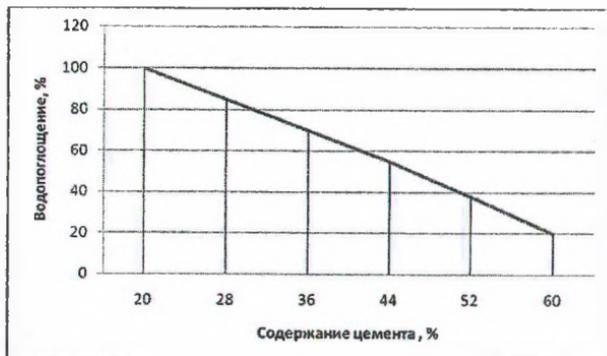
Рисунок 3 – Изменение водопоглощения композита с изменением содержания цемента в смеси
