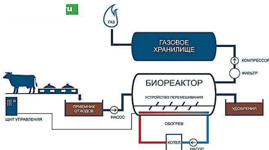
Схема 1. Биогазовая установка
