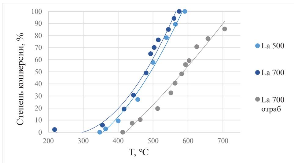
**Рис. 1 - Каталитическая активность образцов  $\text{Ce}_{0.9}\text{Zr}_{0.05}\text{La}_{0.05}\text{O}_{2-\delta}$  при разных температурах прокаливания в реакции полного окисления метана**
